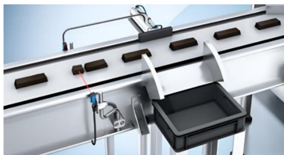
Obr. 21) Příklad aplikace optoelektronických senzorů [31]
