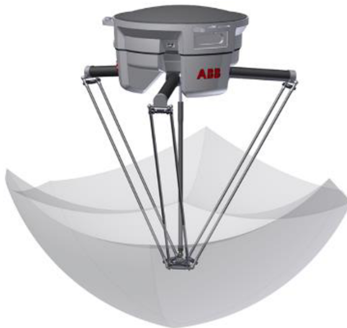
Obr. 8) Delta robot ABB a jeho pracovní prostor [15]
