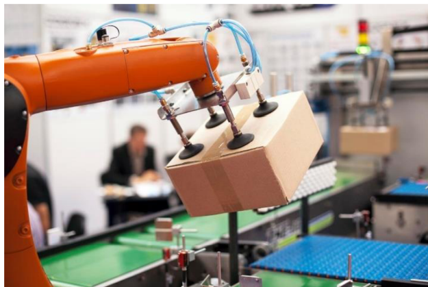
Obr. 15) Příklad aplikace podtlakových úchopných hlavic [23]
