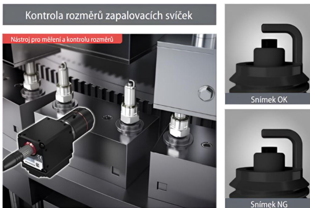
Obr. 19) Vizuální kontrola rozměrů zapalovacích svíček [29]
