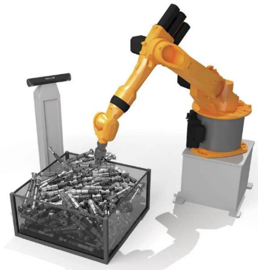
Obr. 5) Průmyslový robot využívající strojové vidění (tzv. bin picking) [9]
