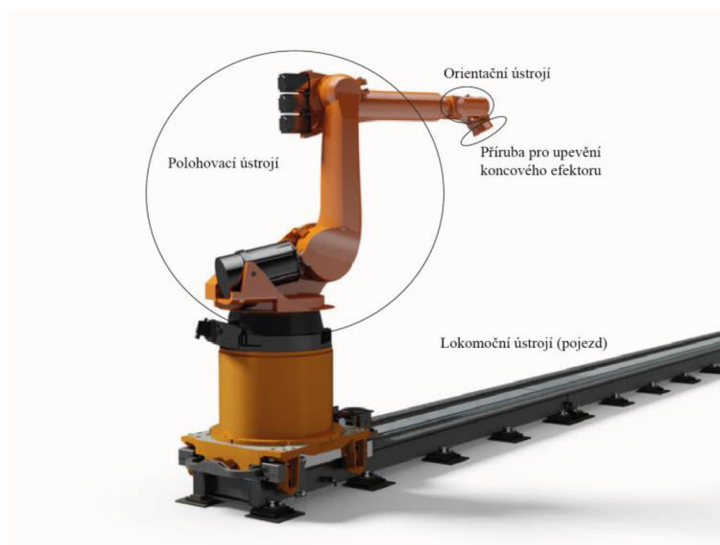
Obr. 3) Ústrojí akčního systému průmyslového robotu [6]
