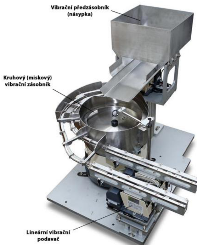
Obr. 16) Typické provedení vibračního podávacího zařízení [25]
