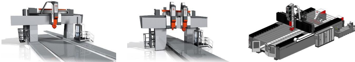
Obr. 29) Koncepce portálových strojů: spodní gantry, pevný portál, horní gantry [18]
