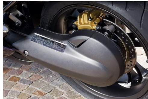
Obr. 7.10 Hydraulická převodovka DN-01 [51]
