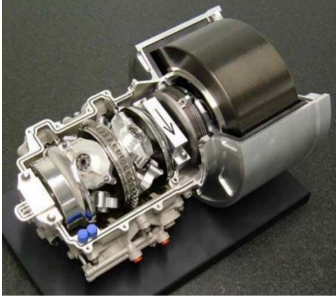
Obr. 4.8 Systém Flybrid použitý ve Formuli 1 [21]
