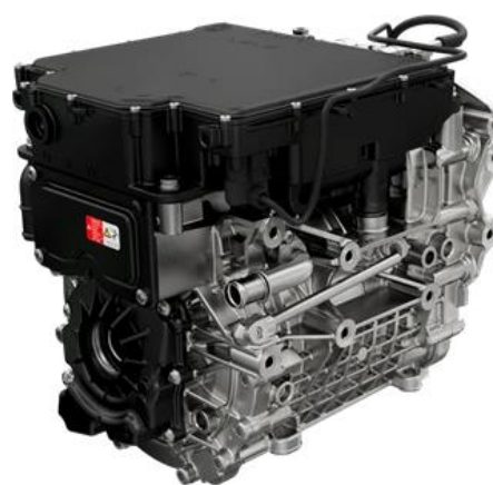
Obr. 6.11 Elektromotor Škody ENYAQ iV 195 kW [40]
