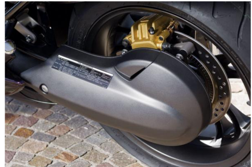
Obr. 7.10 Hydraulická převodovka DN-01 [51]
