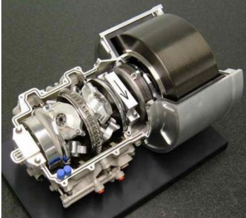
Obr. 4.8 Systém Flybrid použitý ve Formuli 1 [21]
