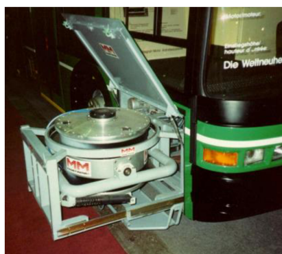
Obr. 5.5 Autobus v Mnichově vybavený setrvačnickem [24] Obr. 5.6 Setrvačnickový modul trolejbusu [24]
