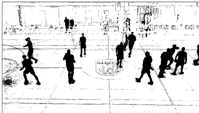
Obrázek 6.3: Segmentační maska vyprodukovaná algoritmem ViBe [3] je velmi zašuměná, z toho důvodu je nutné další zpracování.
