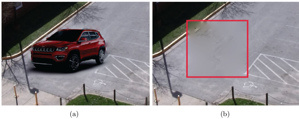
Obrázek 6.12: Seamless cloning algoritmy fungují optimálně v situacích, kdy vkládaný objekt má okolo okrajů podobnou texturu jako okraje cílové oblasti (a). Virtuální grafika nemá skoro žádnou texturu, tudíž způsobí artefakt, který vypadá jako rozmazání cílové oblasti (b).
