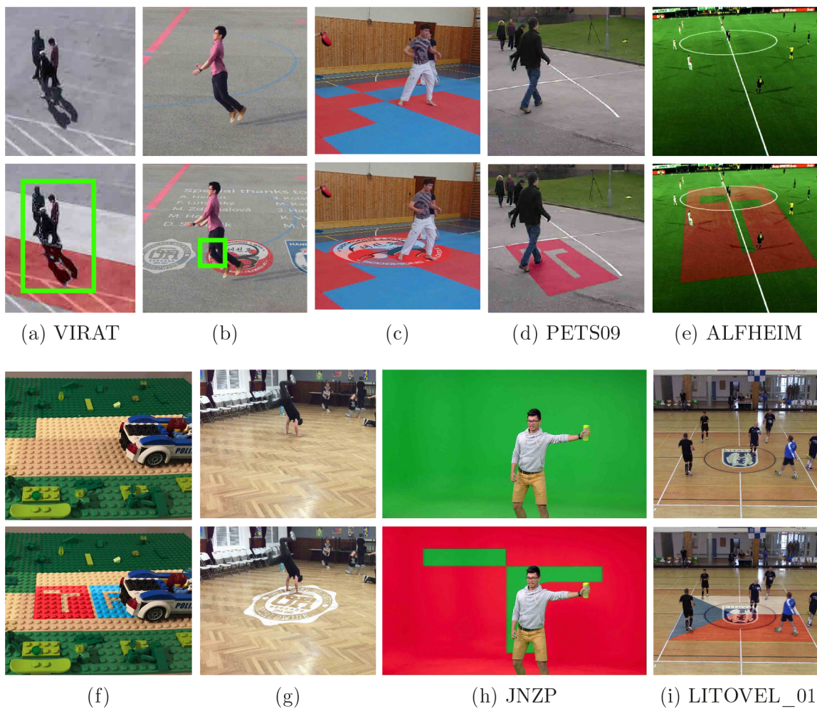
Obrázek 7.4: Otestování systému na různých datasetech. Tmavé stíny (a) jsou chybně klasifikovány jako popředí, nicméně tato chyba není příliš viditelná. Na obrázku (b) špatně klasifikované popředí jako stín způsobí artefakt, který vypadá část pozadí.
