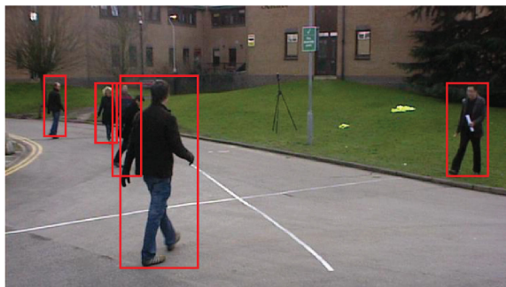
Obrázek 3.4: Červené oblasti představují oblasti, ve kterých se nachází člověk, nalezené detektorem, který je využíván systémem DensePose [25]. Vstupní snímek je z datasetu PETS09.
