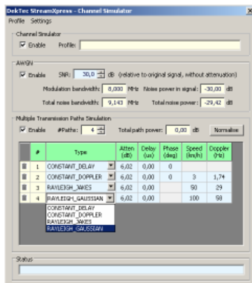
Obr. X.3: Kanálový simulátor přenosového prostředí StreamXpress-Chanel Simulator
