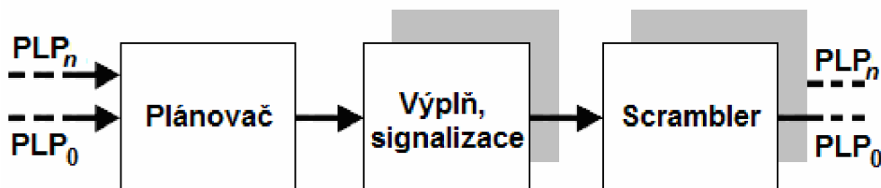
Obr. 3.6: Bloky přizpůsobení PLP_n systému DVB-T2
