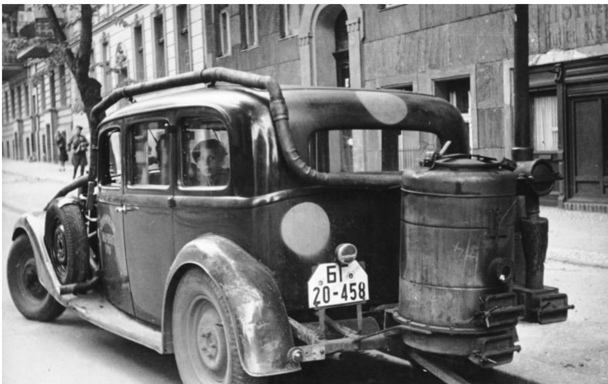
Obr. 7 Automobil s dřevoplynovým generátorem [12]
