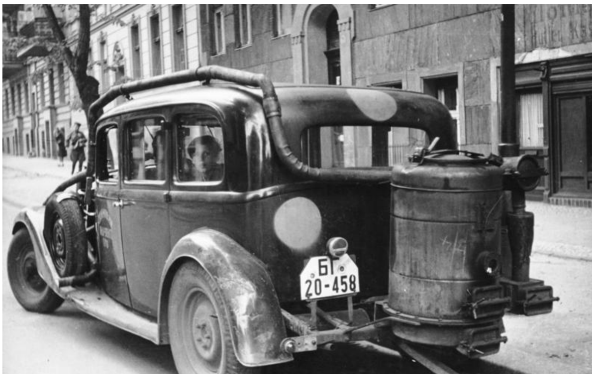
Obr. 7 Automobil s dřevoplynovým generátorem [12]
