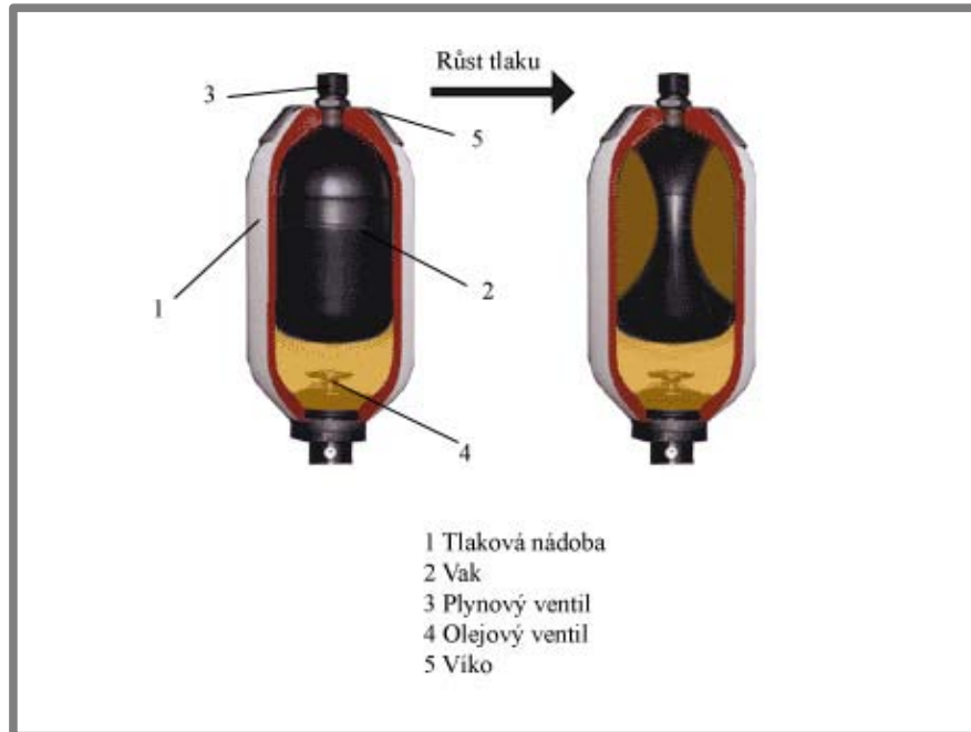
Obr. 2-2 Princip hydraulického akumulátoru (vakového) [8]
