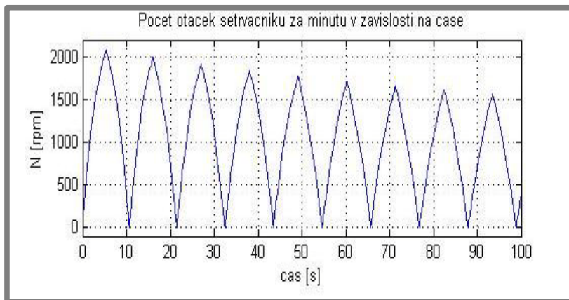
Obr. 6-2 Průběh otáček pro test 1 vypočtený programem
