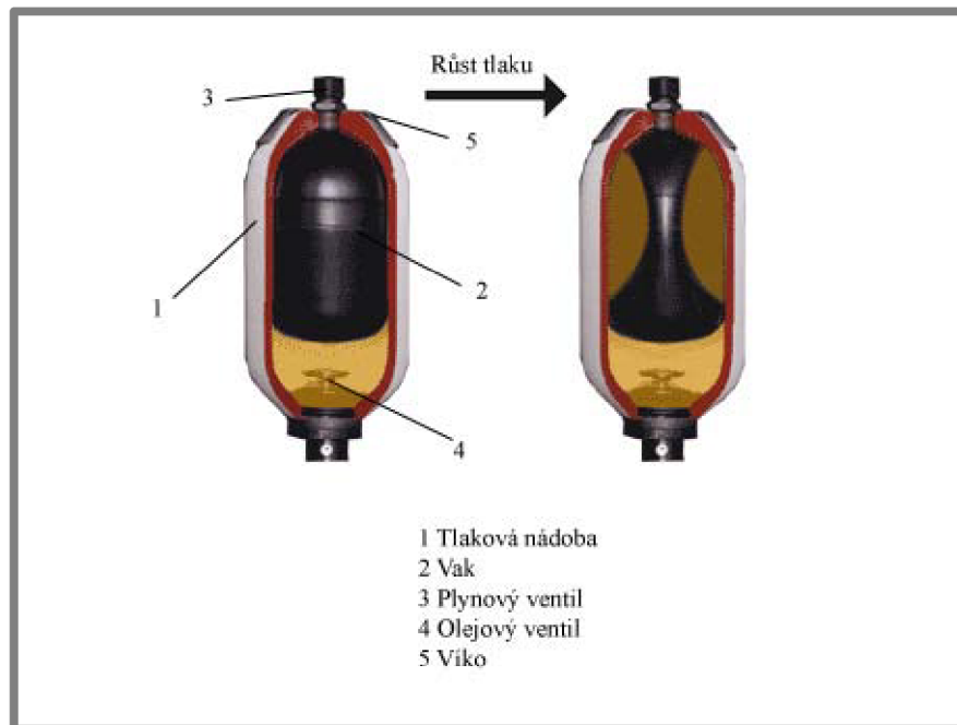
Obr. 2-2 Princip hydraulického akumulátoru (vakového) [8]
