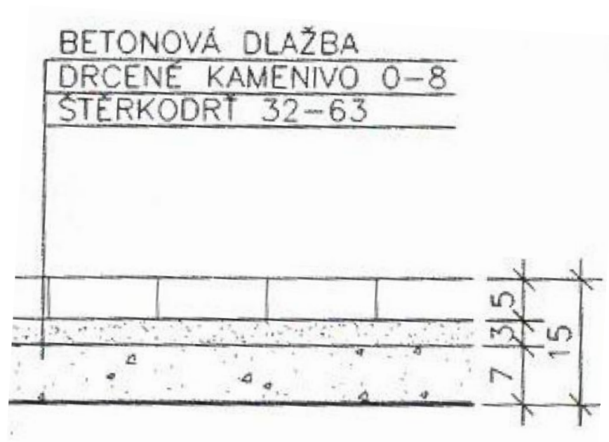
Obrázek 49: Technický řez dlažbou
