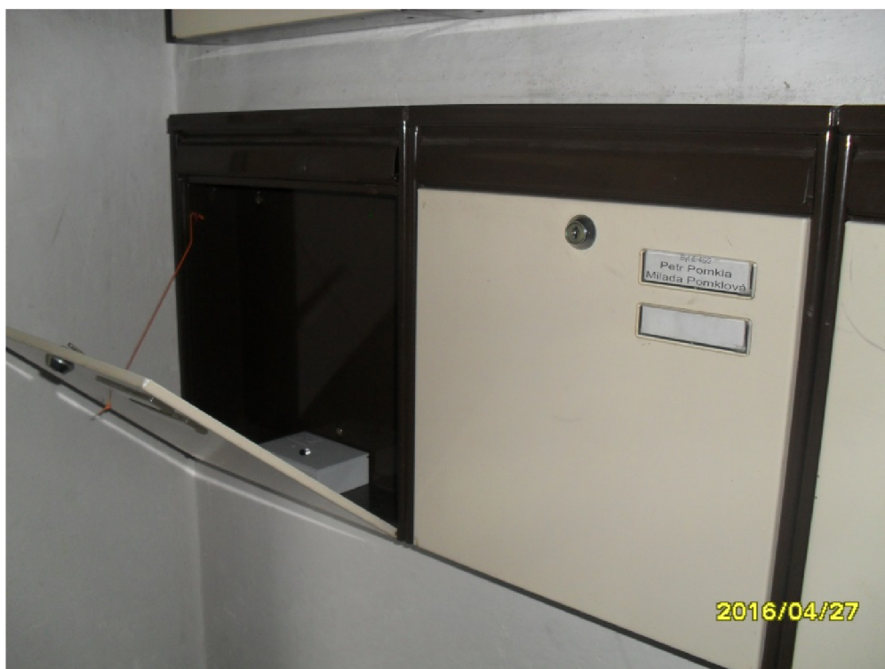
Obrázek E.6: Umístění ESP-01 pro detekci pošty.
