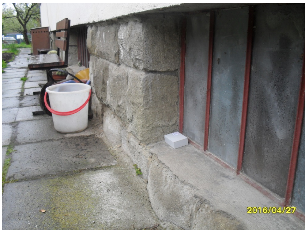
Obrázek E.7: Umístění ESP-01 pro měření teploty.
