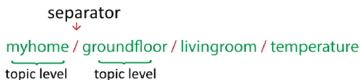
Obrázek 2.15: Hierarchická struktura topics MQTT 27 .
