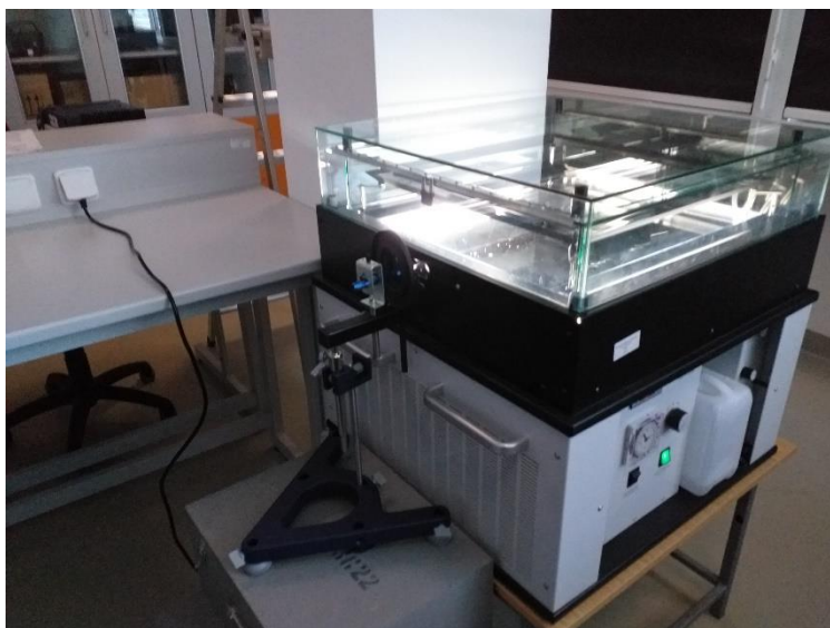
Obrázek 16: Stojan s radioaktivním zářičem před difúzní mlžnou komorou nacházející se v Laboratoři experimentů z moderní fyziky na Katedře fyziky Přírodovědecké fakulty Univerzity Hradec Králové.
