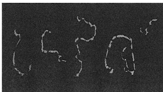
Obrázek 10: Stopy generované částicemi \beta s malou energií.
