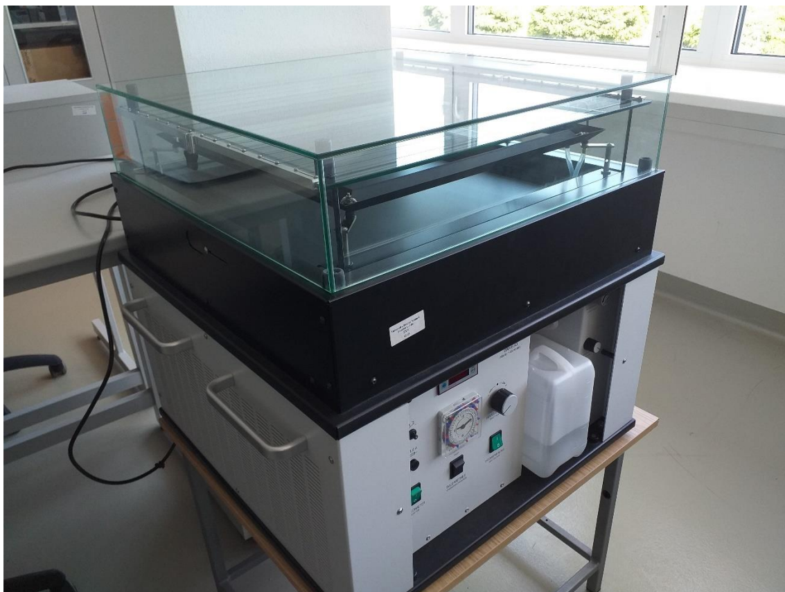
Obrázek 4: Difúzní mlžná komora nacházející se v Laboratoři experimentů moderní fyziky na Katedře fyziky Přírodovědecké fakulty Univerzity Hradec Králové
