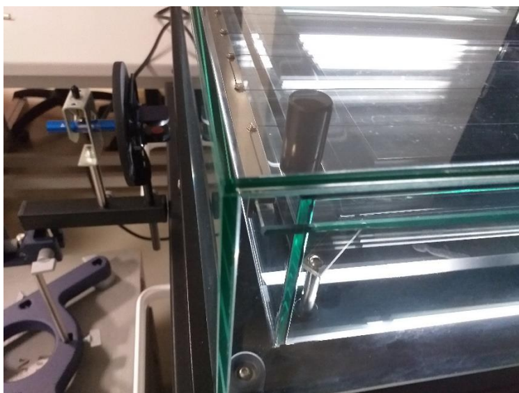
Obrázek 17: Stojan s radioaktivním zářičem před difúzní mlžnou komorou nacházející se v Laboratoři experimentů z moderní fyziky na Katedře fyziky Přírodovědecké fakulty Univerzity Hradec Králové. Pohled zblízka.
