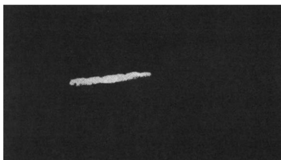
Obrázek 6: Stopa vytvořená částicí \alpha .
