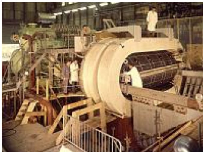
Obrázek 2: Gargamella, těžkovodní bublinová komora v CERNu
