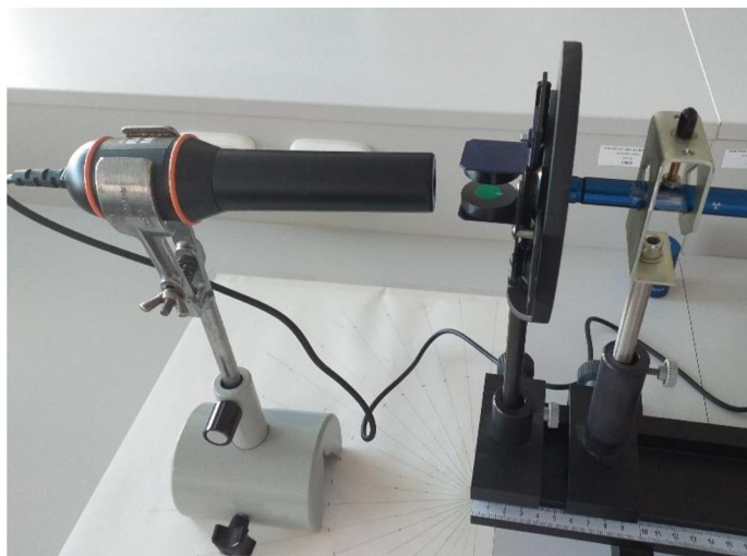
Obrázek 21: Sestavená aparatura k měření rozložení \beta částic s ohledem na úhel odklonu od přímého směru.
