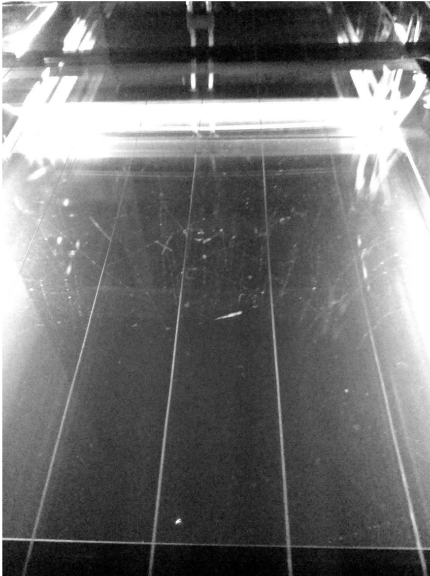
Obrázek 18: Trajektorie vysílaných částic v difúzní mlžné komoře bez magnetického pole
