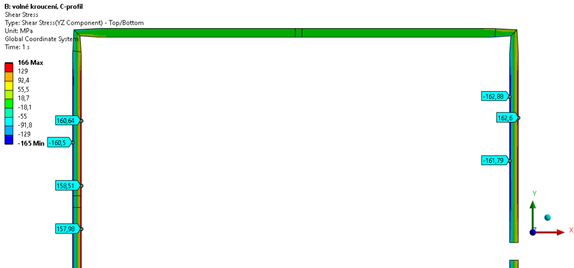
Obr. 7.8 Smykové napětí \tau_{yz} v příčném průřezu
