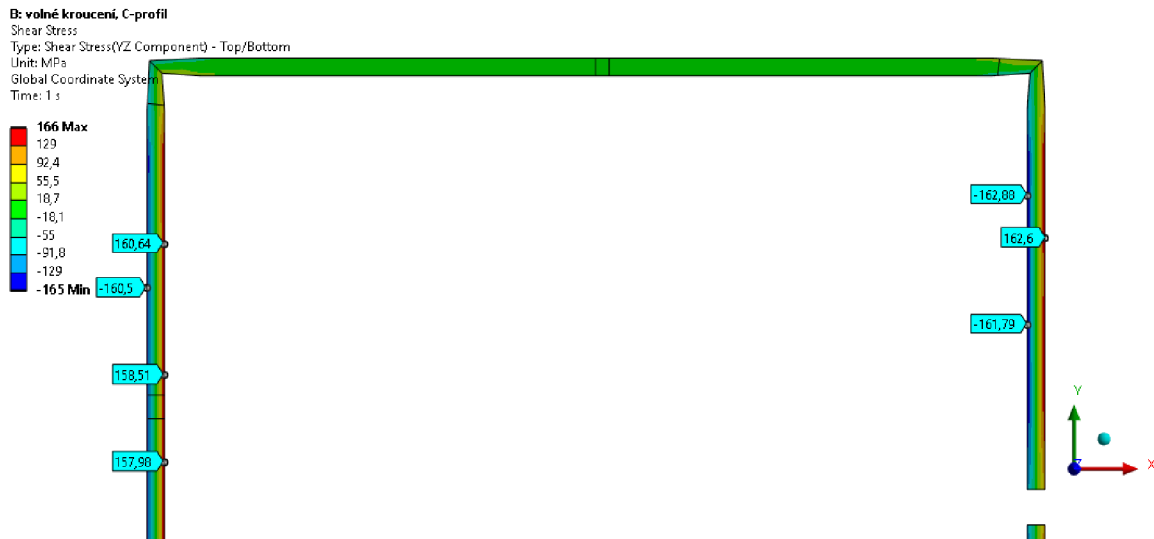
Obr. 7.8 Smykové napětí \tau_{yz} v příčném průřezu
