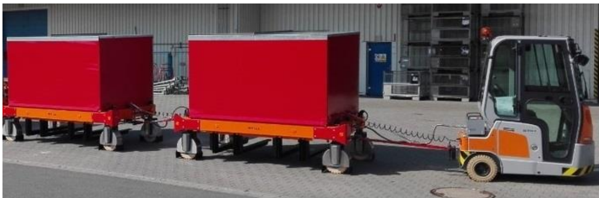
Obr. 1 Tahač s „C“ rámy sloužící pro meziobjektovou přepravu
