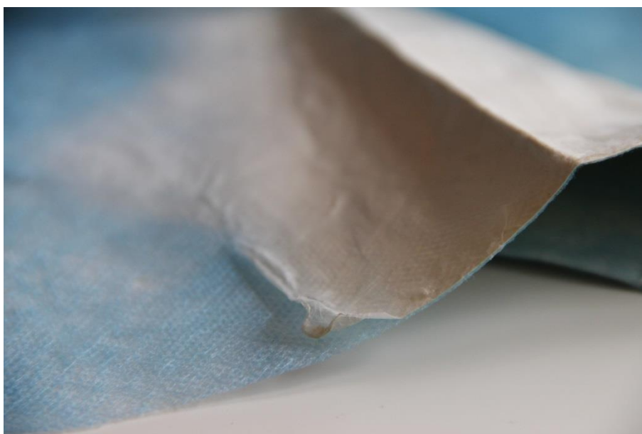
Obrázek 16: Nanovláknenná vrstva fixovaná mezi vrstvami netkané textilie
