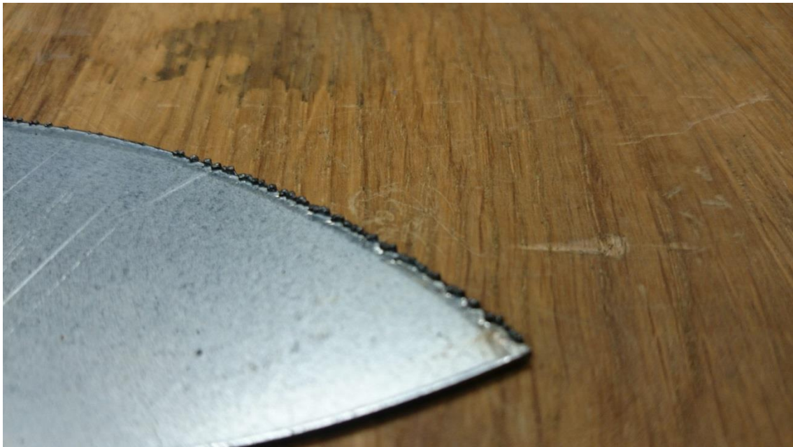
Obr. 26 Detail hrany při použití nesprávné ohniskové vzdálenosti
