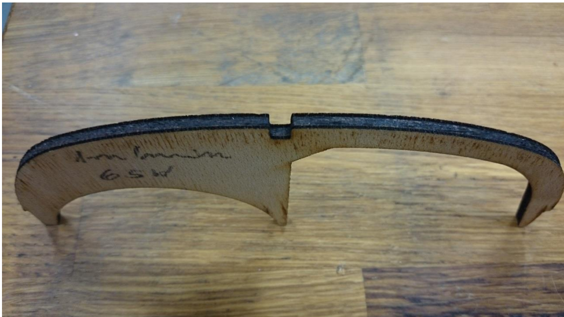
Obr. 25 Řezání překližky, správné ohnisko
