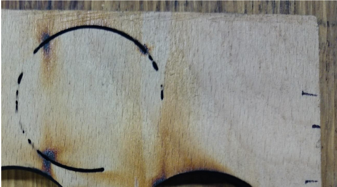
Obr. 24 Spodní strana řezu – překližka, špatné ohnisko
