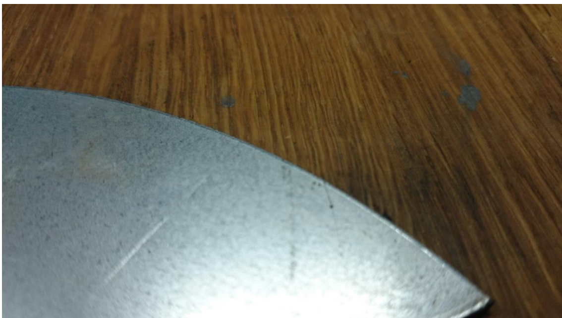
Obr. 27 Detail hrany při aplikaci optimální ohniskové vzdálenosti
