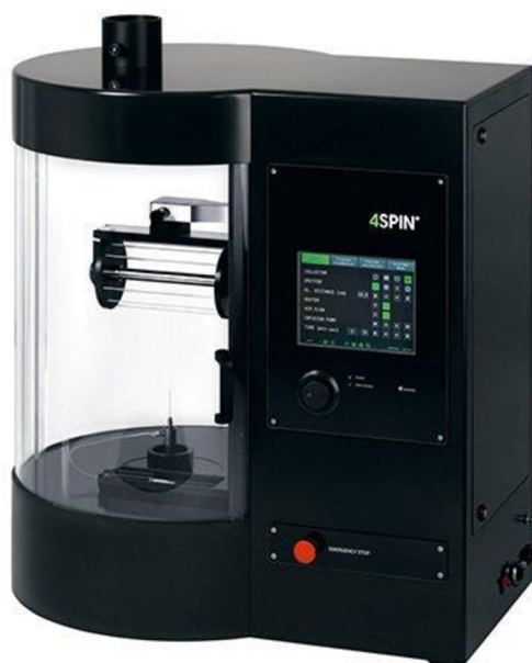
Obrázek 18 - Laboratorní spinovací zařízení (Contipro 4SPIN C4S Lab) [31]
