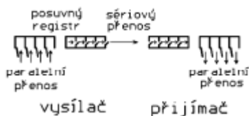
Obr. 3-5 Převod dat pomocí posuvného registru, upraveno z [3]
