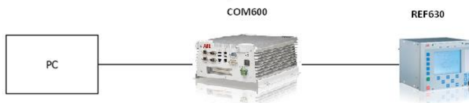
Obr. 7-6 Blokové schéma zapojení při testování komunikace IEC 60870-5-104
