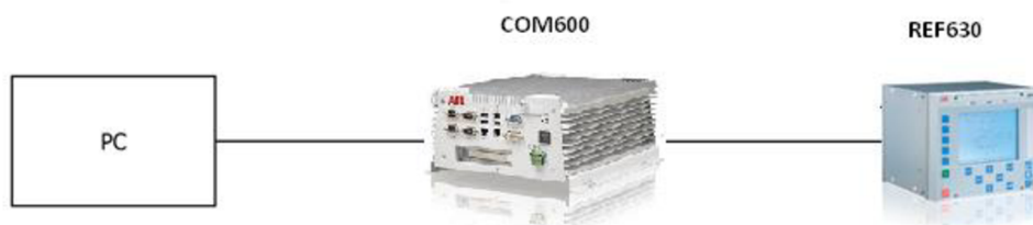
Obr. 7-6 Blokové schéma zapojení při testování komunikace IEC 60870-5-104
