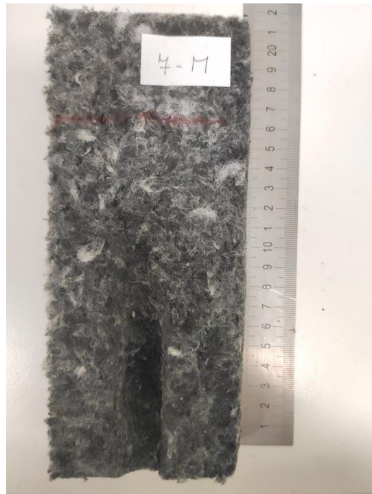
Obrázek 18: Vzorek 7 po zkoušce malým plamenem
