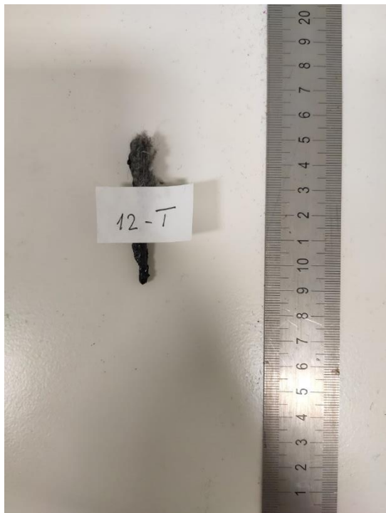
Obrázek 17: Vzorek 12 po zkoušce malým plamenem
