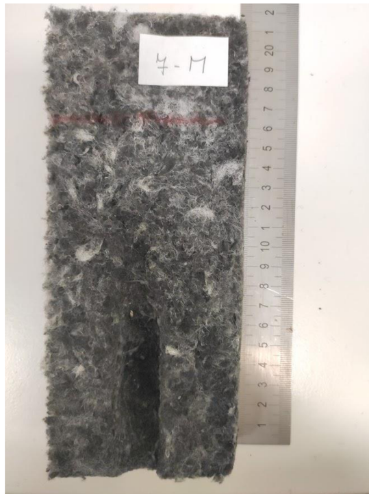
Obrázek 18: Vzorek 7 po zkoušce malým plamenem
