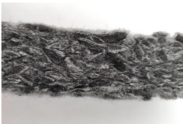
Obrázek 13: Ukázka vločkovité struktury – vzorek 2
