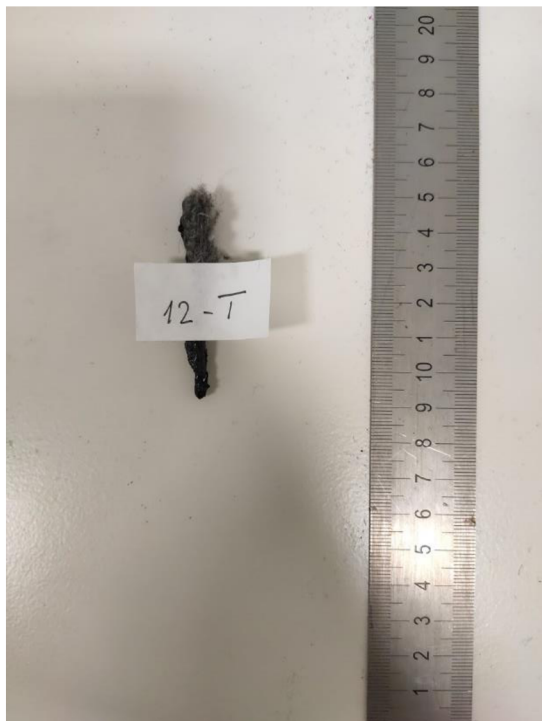
Obrázek 17: Vzorek 12 po zkoušce malým plamenem
