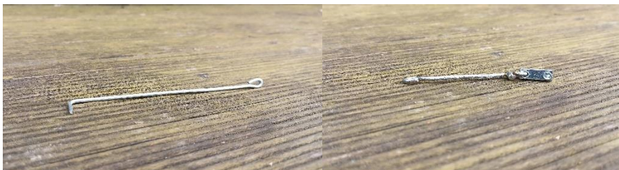
Obr. 29: Ojnice vedoucí k membráně a k přeháněcímu pístu
