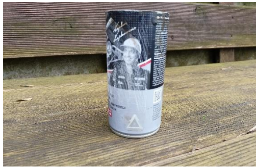
Obr. 23: Válec Stirlingova motoru z plechovky
