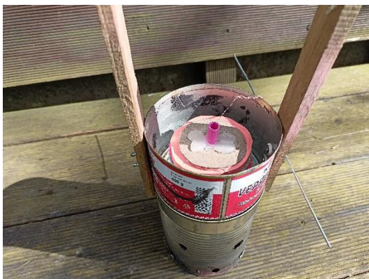
Obr. 31: Stirlingův motor s novou membránou a přeháněcím pístem s výškovým uchycením motoru
