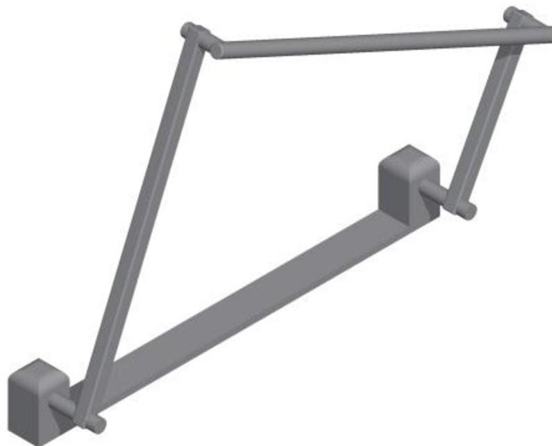
Obr. 3.2 3D model čtyřkloubového mechanismu
