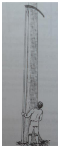
Obr. 2: Měření finskou parabolickou průměrkou (Šmelko, 2000)
