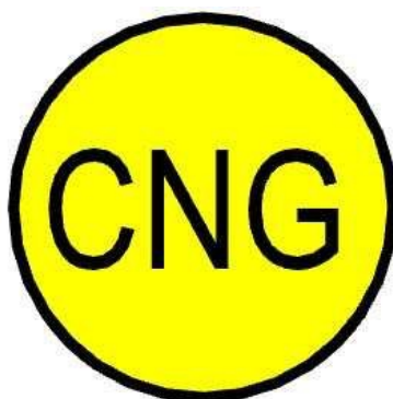
Obr. 2 Označení vozidel kategorie M1 a N využívající CNG [30]
