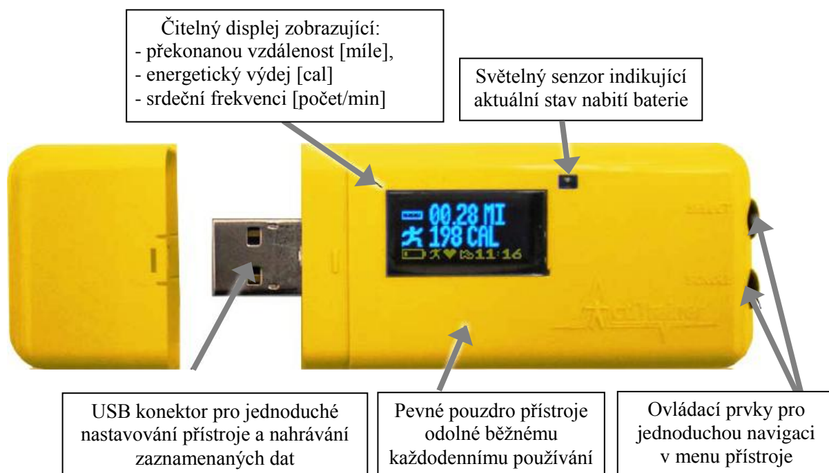
Obrázek 1. Multifunkční monitorovací přístroj ActiTrainer (převzato z práce Sigmund & Sigmundová, 2011, 36)
