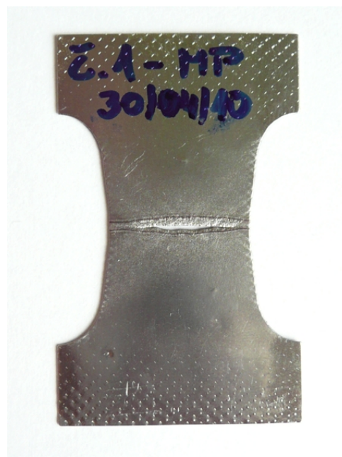
Obr. 9.11 - vzorek MP po zkoušce tahem
