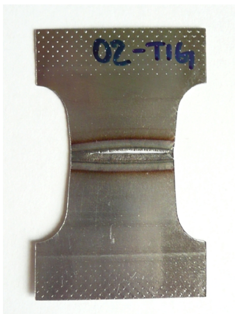
Obr. 9.10 - vzorek TIG po zkoušce tahem
