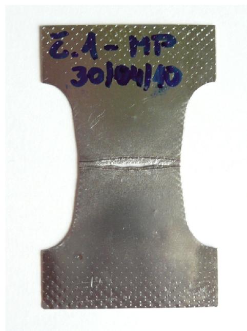
Obr. 9.11 - vzorek MP po zkoušce tahem
