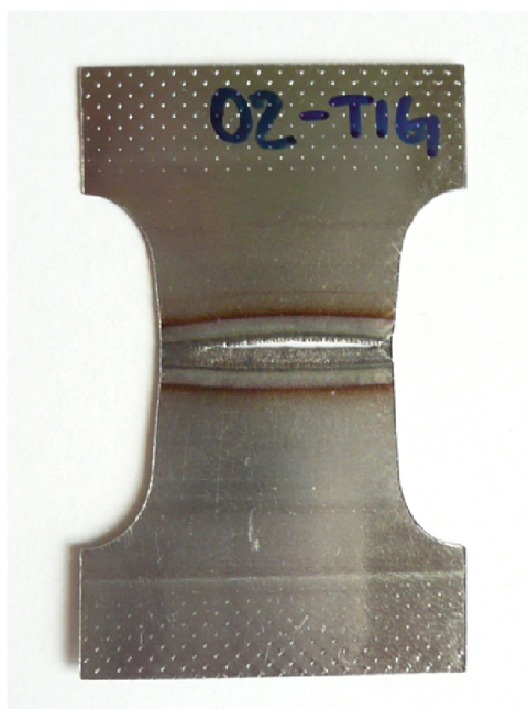
Obr. 9.10 - vzorek TIG po zkoušce tahem
