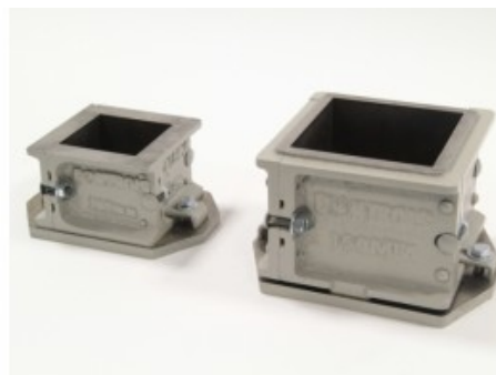
Obrázek 98 - forma na zkuřebnı krychle; zdroj [37]
