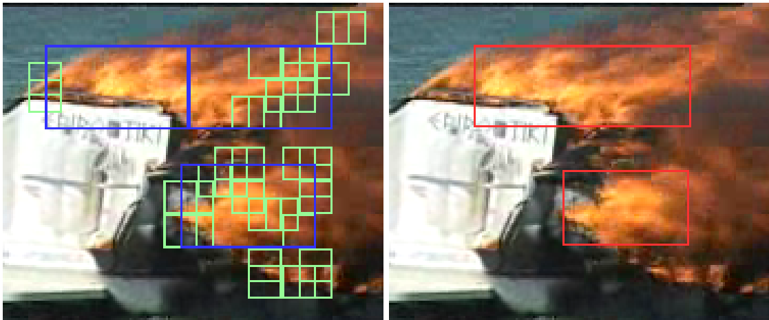
Obrázek 6.14: Vlevo vykreslení interních zpracovávaných oblastí. Vpravo korektní výstup i za nepříznivých povětrnostních podmínek.
