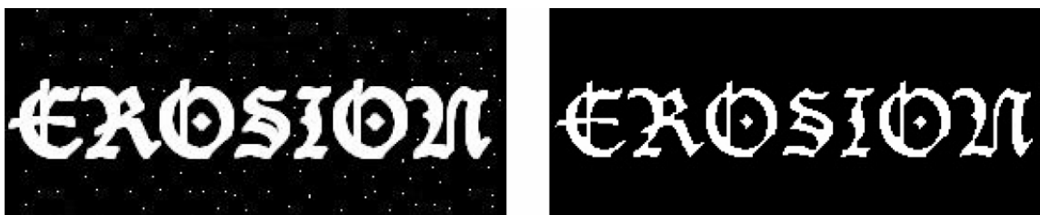
Obrázek 3.2: Ukázka výsledku operace eroze. Převzato z [3].
