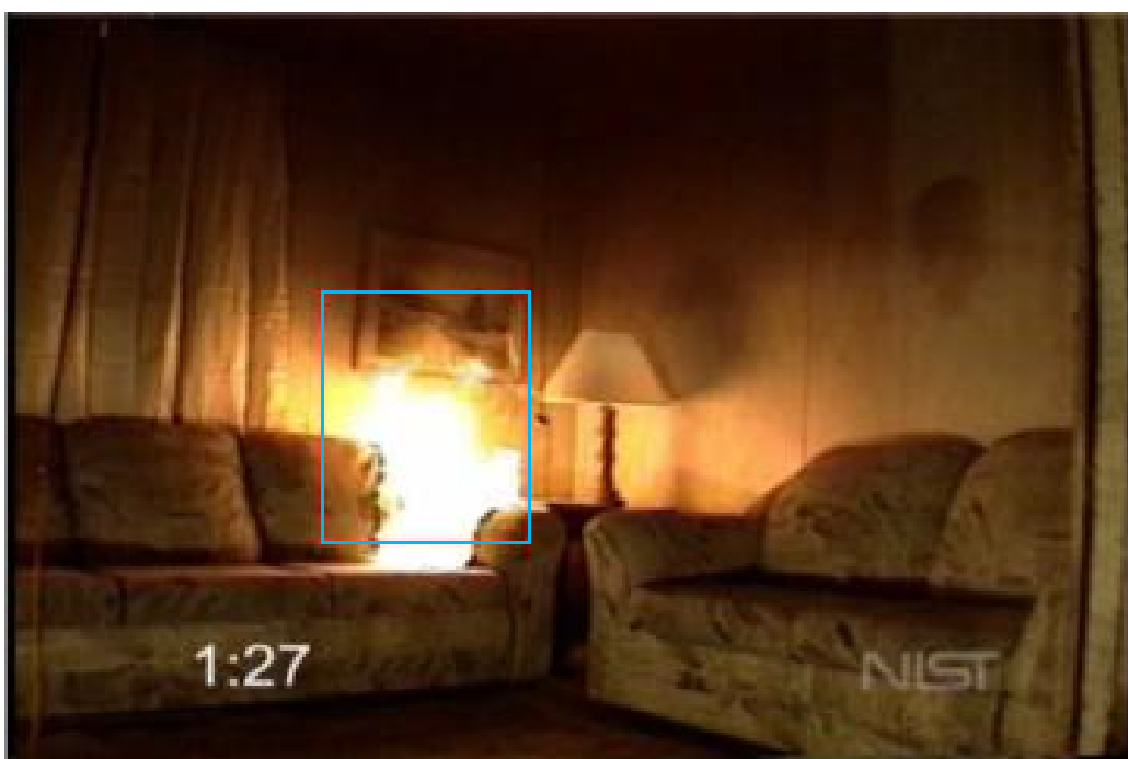
Obrázek A.4: Detekce ve videu, kde požár vznikl vznícením pohovky (např. nedopalek cigarety).
