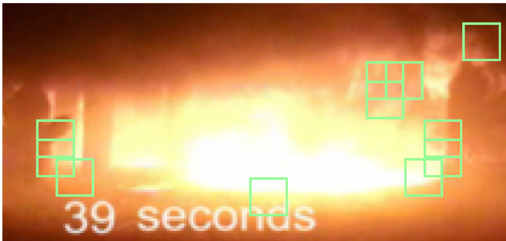
Obrázek 6.11: Efekt rozmazání - detekované oblasti, které neobsahují žádnou velkou oblast z důvodů malých změn.
