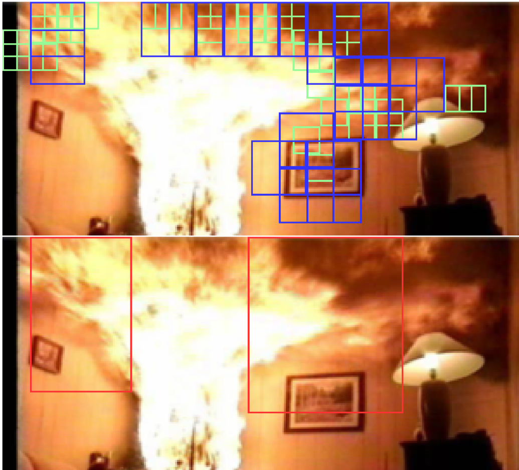
Obrázek 6.8: Pevně daná velikost oblastí - vlevo vykreslení oblastí, kde je názorná segmentace ucelené oblasti ohně. Vpravo výstup detektoru s roztroušenou detekcí.
