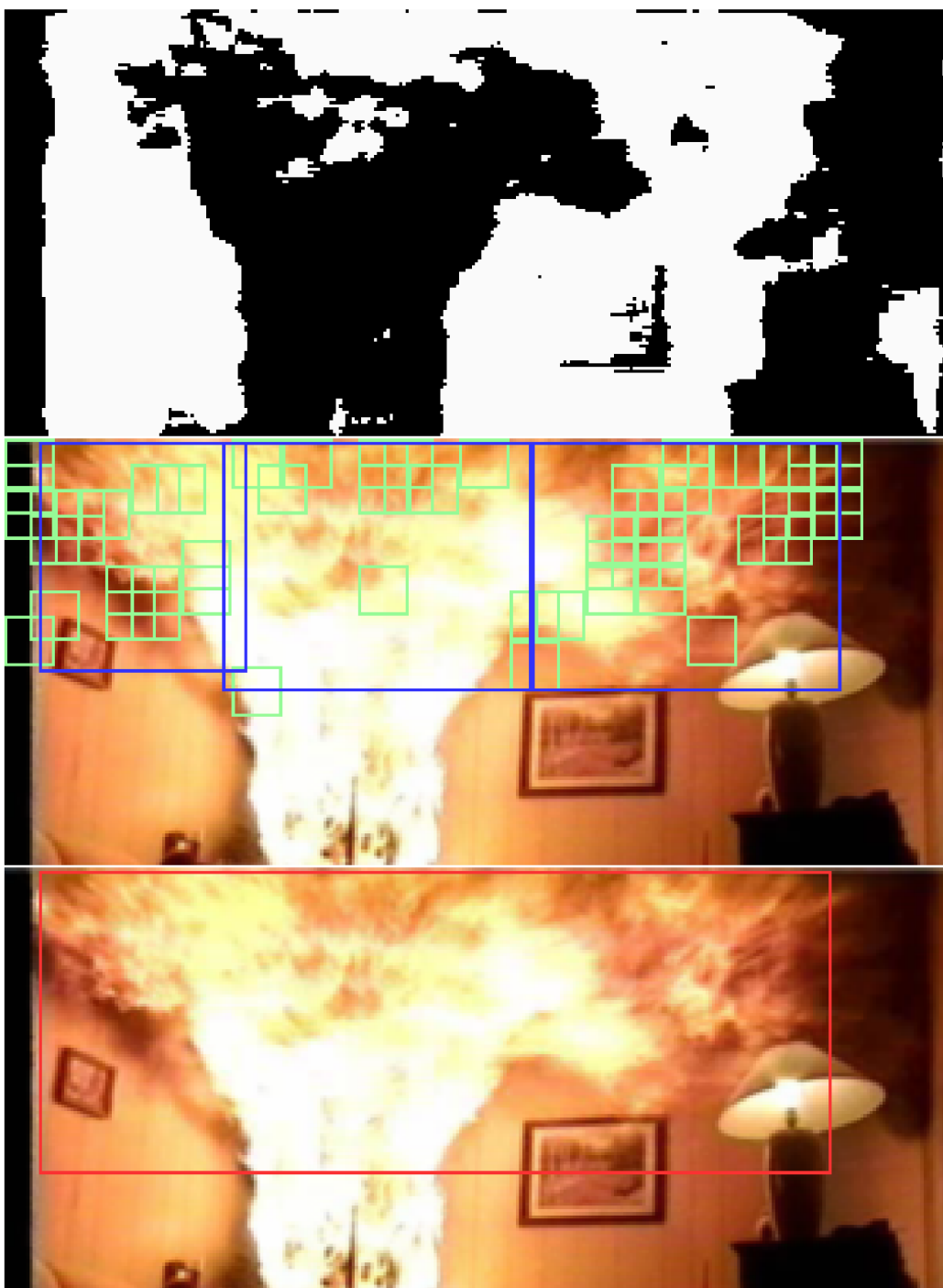
Obrázek 6.6: Korektní detekce - nahoře maska ohňových barev. Uprostřed vykreslení interních zpracovávaných oblastí. Dole korektní výstup.
