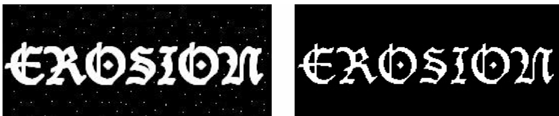
Obrázek 3.2: Ukázka výsledku operace eroze. Převzato z [3].
