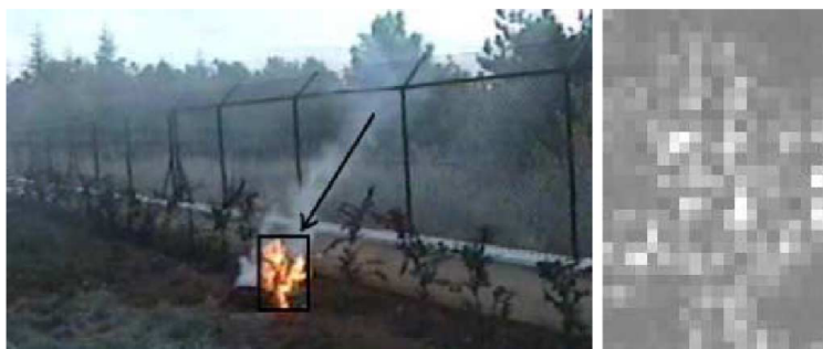
Obrázek 2.3: Zobrazení vlnkové transformace ve výřezu, kde se nalézá oheň. Převzato z [12]
