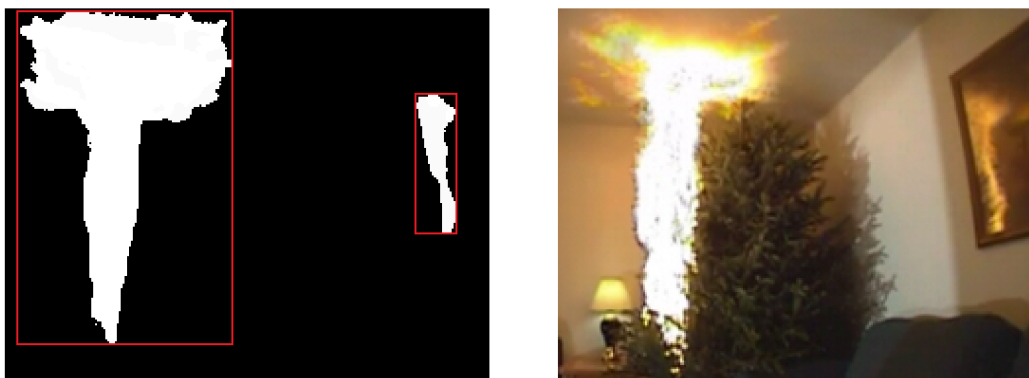
Obrázek 4.1: Vlevo je ideální maska s vyznačením oblastí, která byla ručně upravena. Vpravo je originální snímek.
