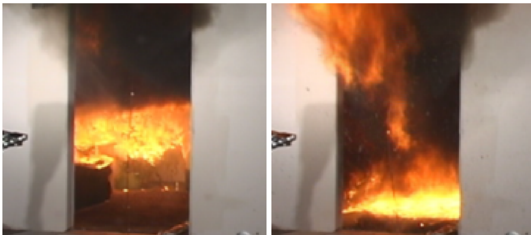
Obrázek 6.1: Vlevo jsou plameny ohně skryty množstvím kouře. Vpravo pronikají ven.
