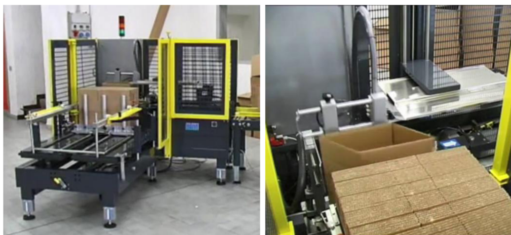
Obr. 4.1 Automatický skládací stroj Siat [5]
