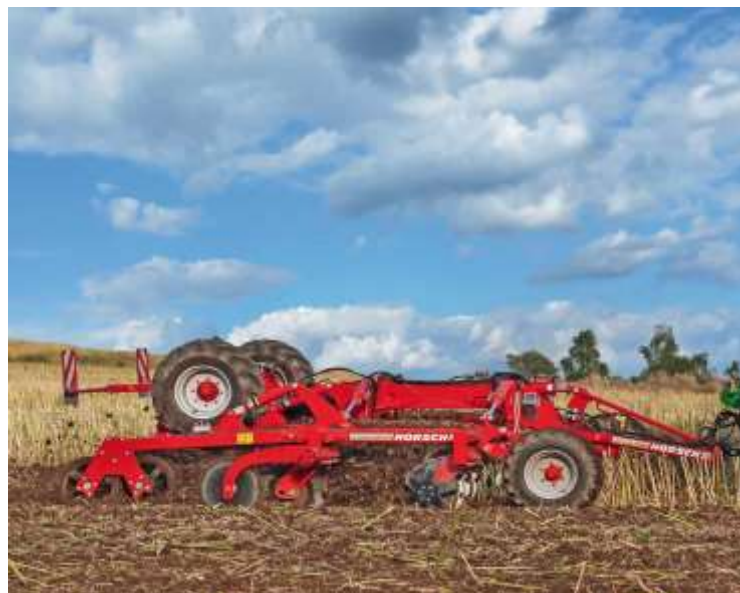
Obr. č. 9: Vysoká provozní jistota a kvalita zpracování půdy diskovým podmítačem je zajištěna díky širokému odstupu talířů a pěchu (Internetový zdroj č. 8)
