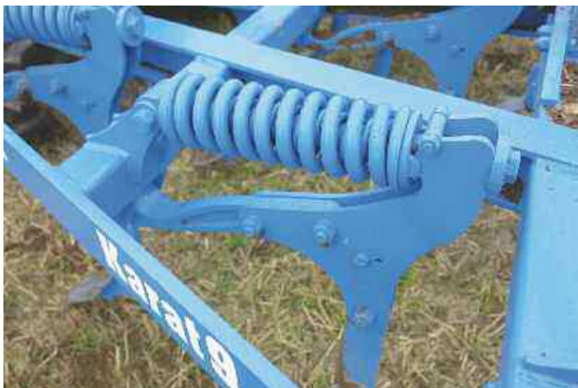
Obr. č. 4: Automatická pojistka proti přetížení. Narazí-li radlička na překážku, zvedne se vzhůru a dozadu, poté se opět rychle vrátí do původní pracovní polohy (Internetový zdroj č. 6)
