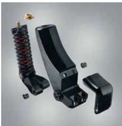
Obr. č. 15: Pracovní jednotka TerraGrip, zdvih 30 cm, počáteční odpor 500 kg, zcela bezúdržbová jednotka (Internetový zdroj č. 11)
