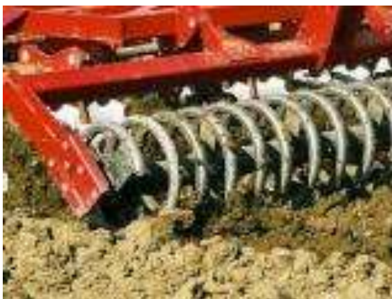
Obr. č. 19: Spirálový válec má vyšší rovnací účinek. Je vybavený čistící lištou a je málo náchylný k zalepování při práci za mokra. (Internetový zdroj č. 12)
