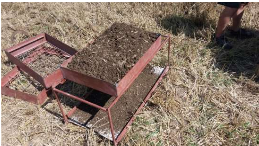
Obr. č. 33: Zachycené částice zeminy na síti s oky 10 x 10 mm. (foto: R. Šimek)
