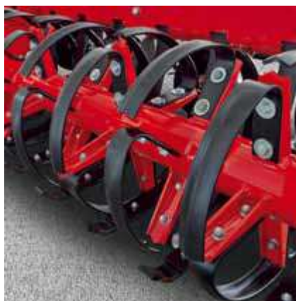
Obr. č. 6: Pěch RollFlex (Internetový zdroj č. 8) slouží k hlubokému utužení půdy při zachování polokypřého povrchu.
