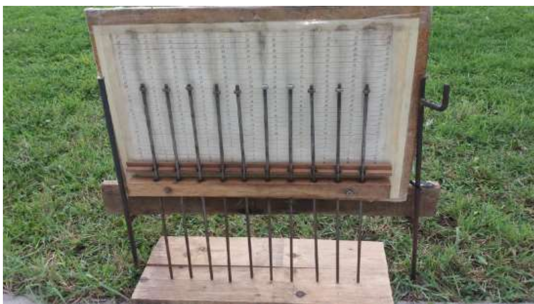
Obr. č. 23: Měřicí deska pro přesné měření hloubky provedené podmínky (foto R. Šimek)
