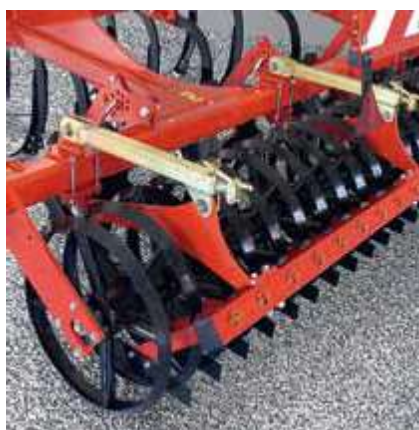
Obr. č. 7: Pěch RollCut (Internetový zdroj č. 8) dosahuje díky prstencům a meziostřím intenzivního drobení hrud.
