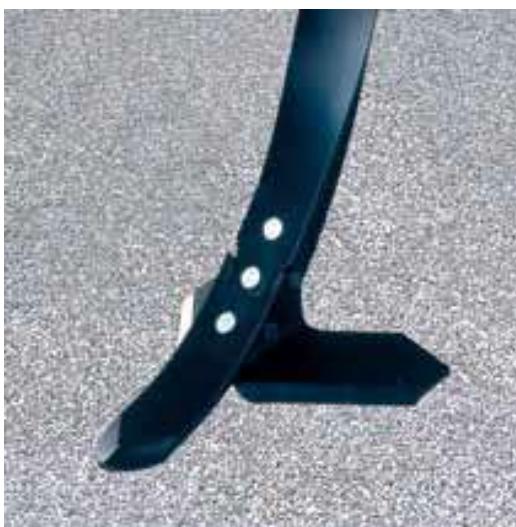
Obr. č. 13: Radlička MulchMix šetrně rozebírá půdu, intenzivně ji promíchává a pracuje celoplošně (Internetový zdroj č. 11)
