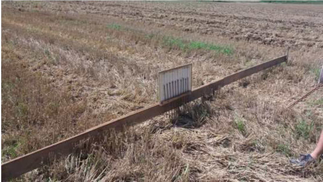
Obr. č. 24: Měřicí deska uchycena na měřicí lati před průjezdem pracovní soupravy (foto R. Šimek)
