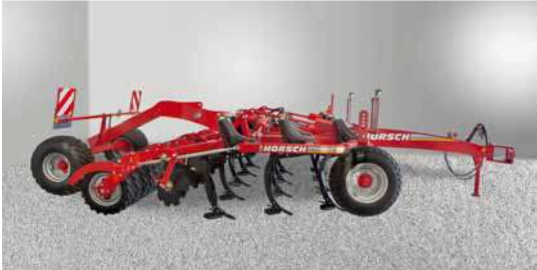
Obr. č. 5: Radličkový podmítač s šípovitými radličkami MulchMix, uovňavacími talíři a pneumatikovým pčhem s velkou opěrnou plochou (Internetový zdroj č. 7)
