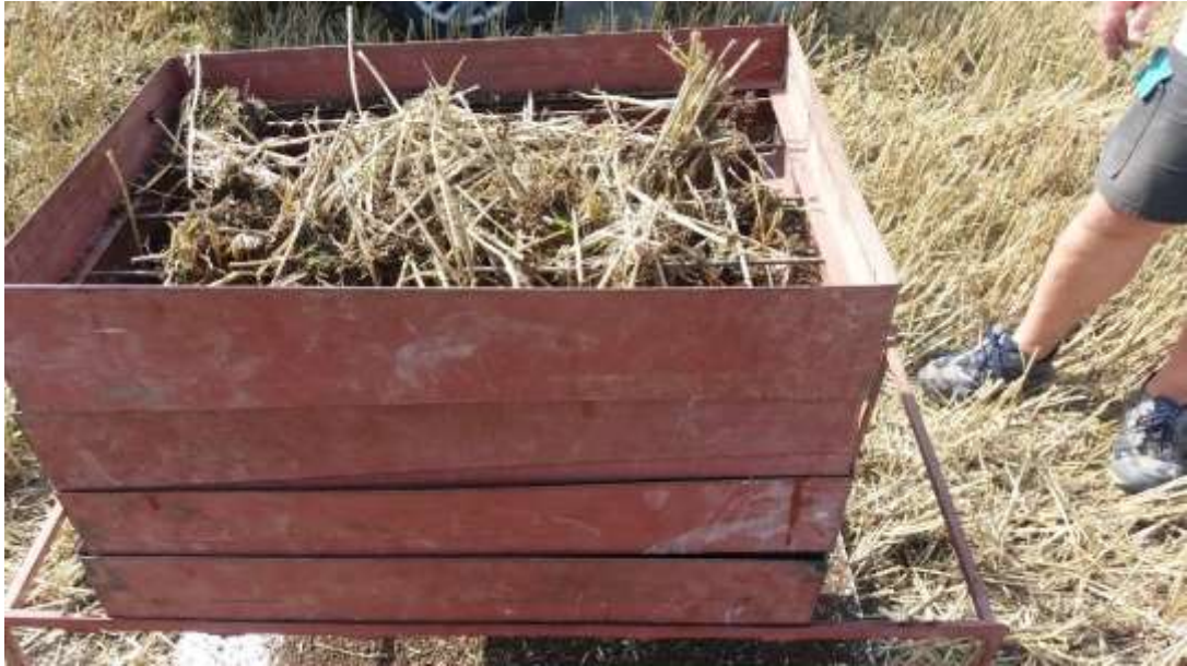
Obr. č. 32: Soustava sít pro zjištění zastoupení jednotlivých kategorií hrud. (foto: R. Šimek)
