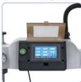
Komfortní práce: Nastavení velikosti závitů, stoupání, počtu otáček a hloubky vrtání přímo přes integrovanou dotykovou obrazovku
