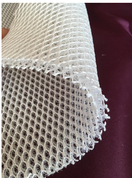
Obrázek 9: Filetová vazba distanční pleteniny
