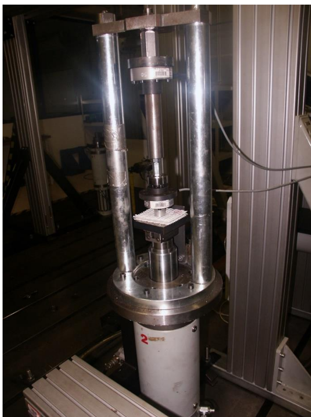
Obrázek 35: Plošné namáhání na hydraulickém testovacím zařízení
