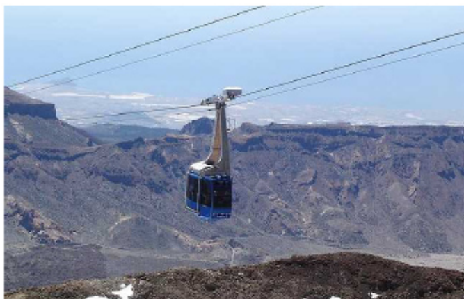
Obr. č. 28 Lanovka, působící síla se rozloží na oba konce lana [26]
