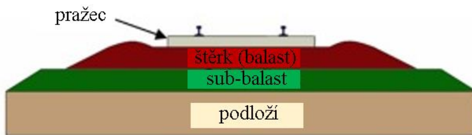
Obrázek 3: Klasická konstrukce trati (převzato a upraveno z [11])
