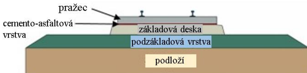
Obrázek 4: Pevná konstrukce trati (převzato a upraveno z [11])
