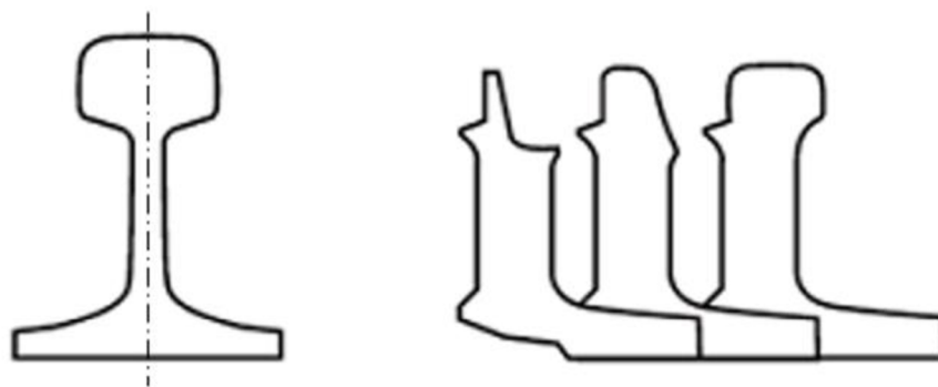
Obrázek 2: Profil přímé kolejnice a profil jazyka, měnící se po délce [7]
