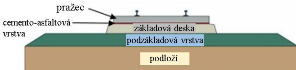
Obrázek 4: Pevná konstrukce trati (převzato a upraveno z [11])
