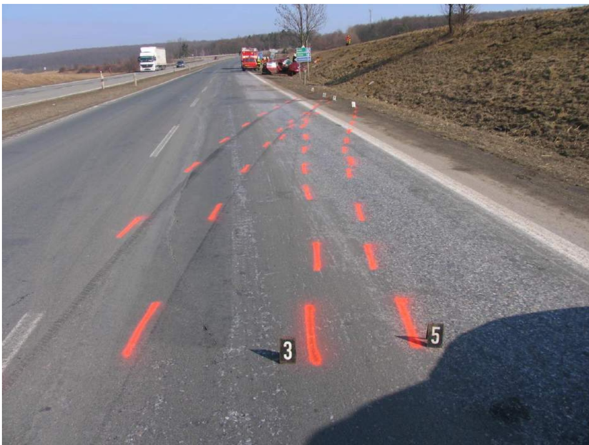
Obr. č. 13 – Smykové stopy a konečná poloha vozidla 49
