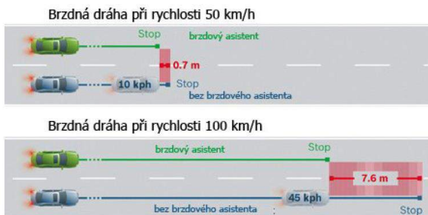
Obr. 6 – Porovnání brzdných drah s a bez systému BAS 33
