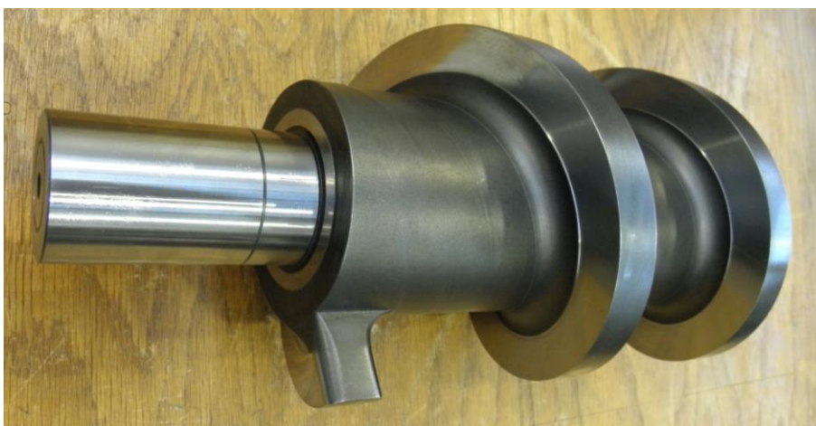
Obr. 3.4. Hotová axiální vačka po broušení.
