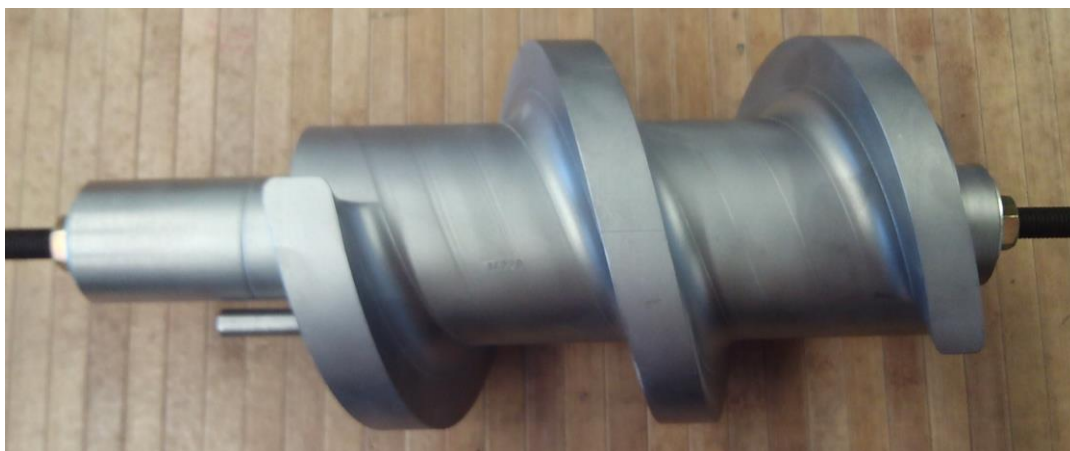
Obr. 11.13. Axiální dvojvačka před finálním broušením.
