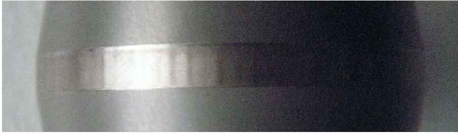
Obr. 6.7. Poškození testovaného vzorku bez mazání.
