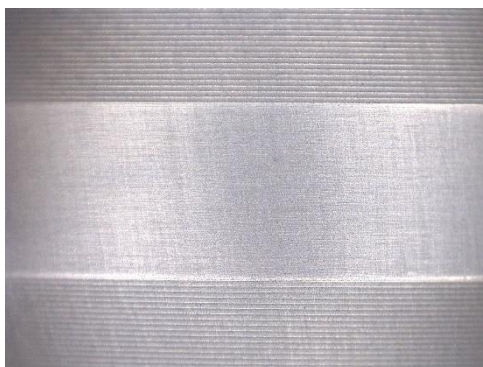
Obr. 6.5. Povlak BALINIT C-STAR na nové netestované rolně.
