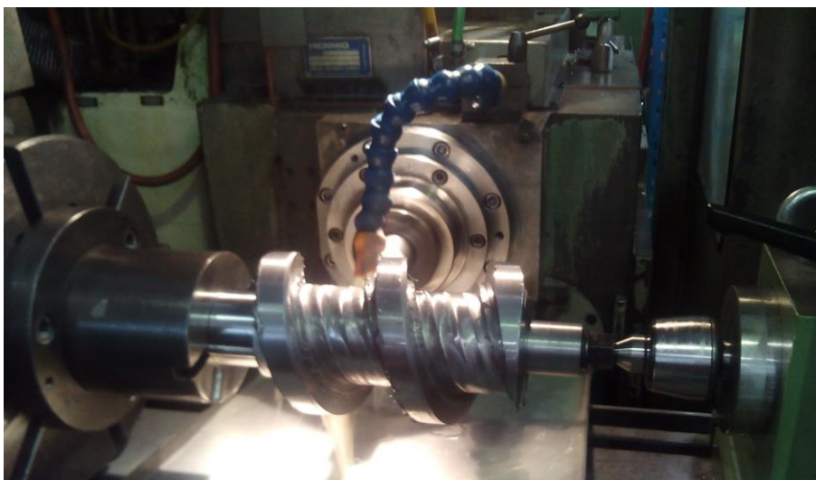
Obr. 3.3. Výroba axiální vačky na stroji SIG. Hrubování.
