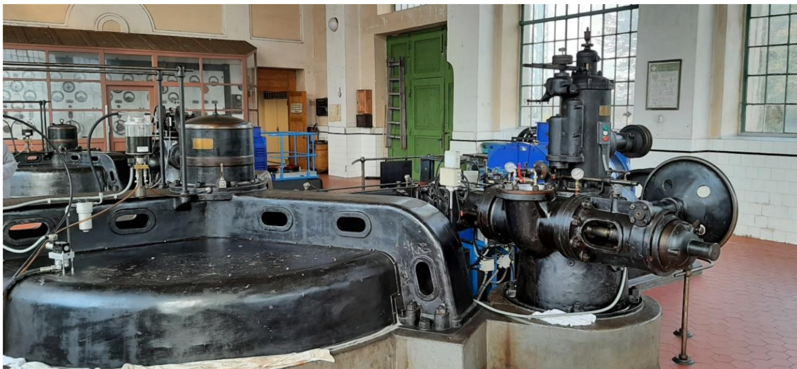
Obr. 9 Kryt převodovky a regulátor otáček
