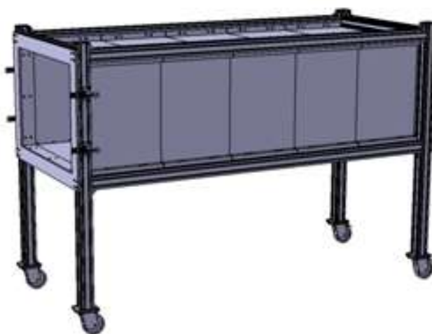
Obr. 1.2: Základní vzhled měřicí sekce – počítačový model [12]
