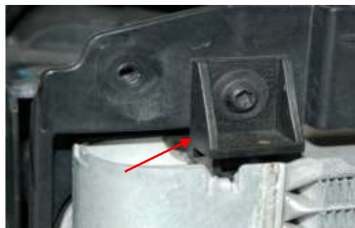
Obr. 2.5: Příklad zajištění chladiče do rámu vlevo nahoře [17]
