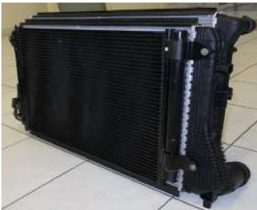
Obr. 2.6: Trojpaket chladičů pro motor 1,6 TDI/77 kW (Škoda Yeti) [18]
