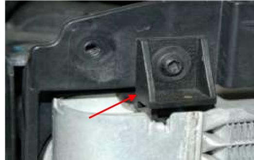
Obr. 2.5: Příklad zajištění chladiče do rámu vlevo nahoře [17]
