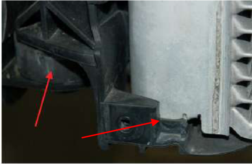
Obr. 2.4: Příklad zajištění chladiče do rámu vlevo dole [16]
