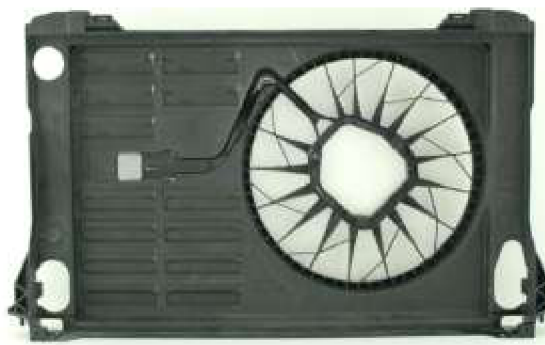
Obr. 2.3: Příklad nosného rámu hliníkového chladiče [15]
