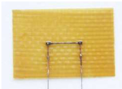
Obr. 6.11: Monokrystalický tenzometr s podložkou [122]
