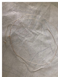
Obr. 4.26: Drát s povrchovou úpravou imerzním stříbrem
