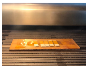
Obr. 4.48: Vzorky během průchodu pecí
