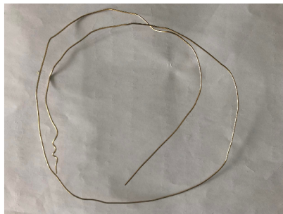
Obr. 4.36: Drát s povrchovou úpravou ENIG
