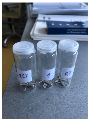
Obr. 4.1: Vzorky měděného drátu s povrchovou úpravou imerzním Sn
