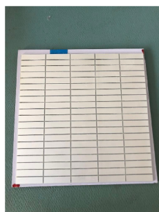
Obr. 4.31: Deska s povrchovou úpravou imerzním stříbrem
