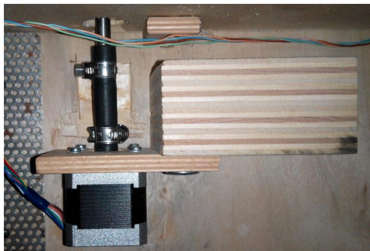
Obrázek č. 18: Sestava motoru osy Z
