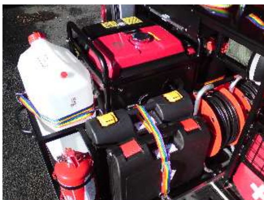
V detailu nezávislý zdroj el. energie, moduly GPS, batohy první pomoci, pomocný hasicí systém
