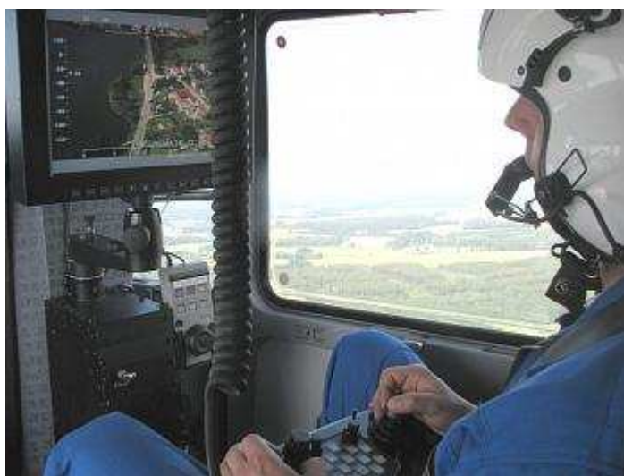
Pozorovací pracoviště s vyhodnocovací jednotkou ve vrtulníku PČR
